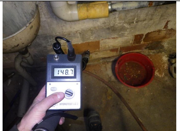
Kuva 32 – Paikoin kohonneita kosteusarvoja kellarin seinärakenteessa
