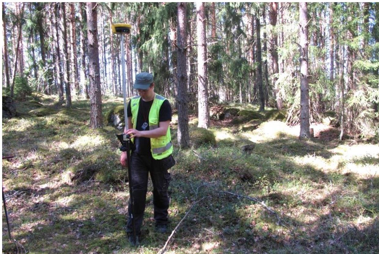
Kuva 13. Mittauksissa käytettiin RTK-korjattua GNSS-paikanninta. Jerry Möller mittaa kairapisteen nro 10 sijaintia selvitysalueen koilliskulman kivikkoiseen ja loivaan rinteeseen. Kuva: Hannu Takala, Maanala Oy.
